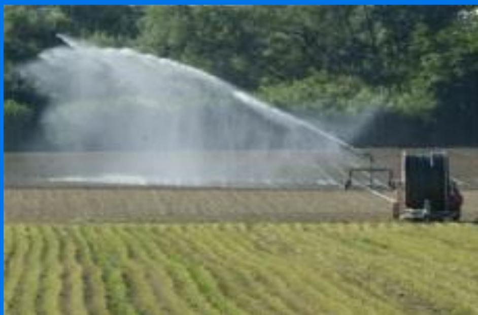
L'irrigazione per aspersione è ormai principalmente effettuata macchine irrigue semoventi (rotoloni) e grandi macchine (Pivot e Rainger) nelle aziende di maggiori dimensioni. Tutte sono state innovate, con **tecnologie di controllo e della regolazione della pluviometria** e con diffusori dell'acqua a bassa necessità di energia che hanno molto migliorato l'efficienza di distribuzione dell'acqua.
