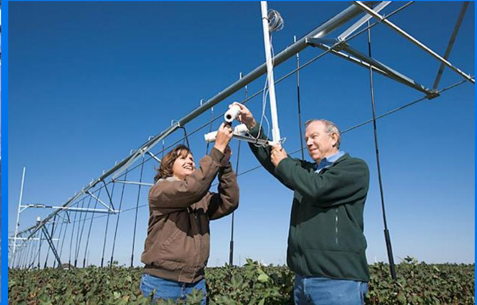
Talvolta il monitoraggio è effettuato direttamente a terra dalle grandi macchine (Pivot e Rainger) abbinate a tecnologie in grado di comandare il flusso degli irrigatori secondo le esigenze della microzona coltivata.
