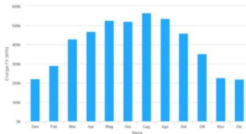
Energia prodotta dal sistema FV fisso:
