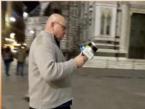
Scanner Mobile con tecnologia SLAM
