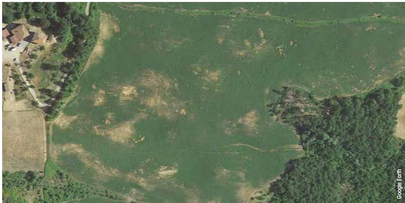
Evidenti segni di erosione su terreni coltivati con forte componente sabbiosa e pendenze intorno al 25% (Monzuno, Bo). Le regimazioni presenti sono costituite esclusivamente da solchi acquai con pendenze troppo elevate
